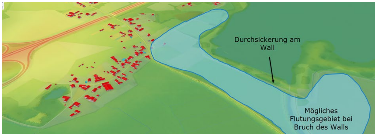
Abbildung 6: Überflutungsanalyse im Rahmen eines Starkregenereignisses, Quelle: VOST THW
